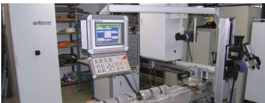
Die modernen automatisierten Lichtbogenschweißanlagen von aixcon produzieren eine Schweißnaht die qualitativ hochwertiger und zudem reproduzierbar ist.
